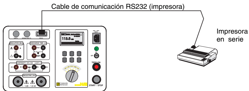
Fig.28. Conexión de C.A 6121 COMPROBADOR DE MAQUINARIA ELECTRICA con impresora en serie.
