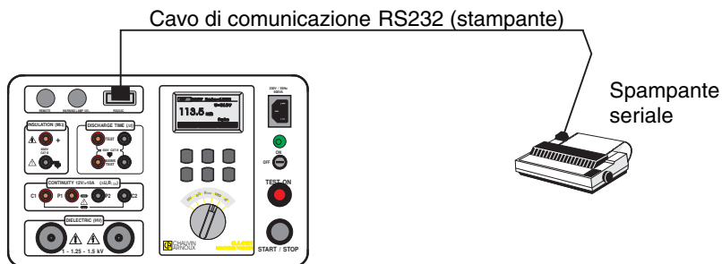
Fig.28. Connessione del C.A 6121 MACHINE TESTER ad una stampante seriale.
